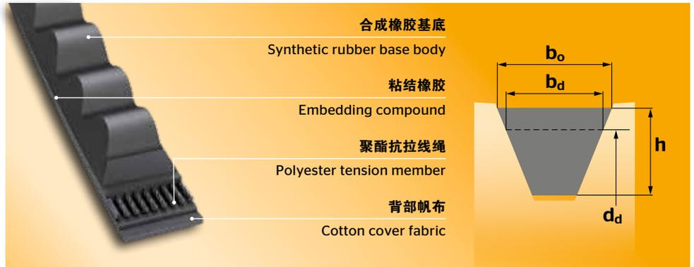
CONTI®V FO 适合小型带轮传动工况，专为高速的工业传动系统而设计。适用于轻型传动系统，如：干燥器和园艺设备。
