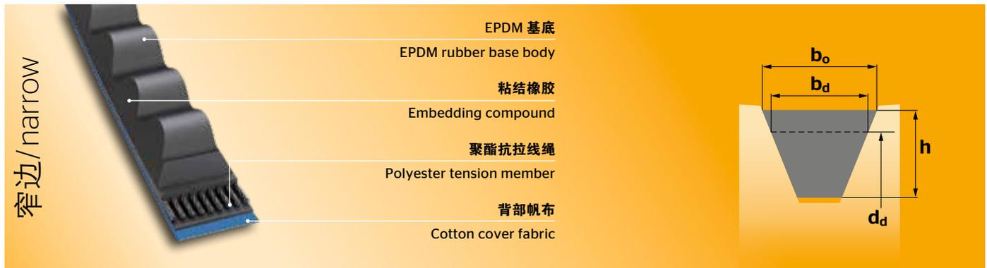
CONTI®V FO PIONEER 可替代任何与包布三角带匹配的传动系统。典型应用领域包括: 压缩机、施工机械、电动切割机、排气扇、石油工业专用泵。三角带十分耐用, 竞争优势在于它的系统成本比包布窄边三角带节省 50%。其优化后的齿面能够保证运行顺畅, 并起到减小振动的作用。
