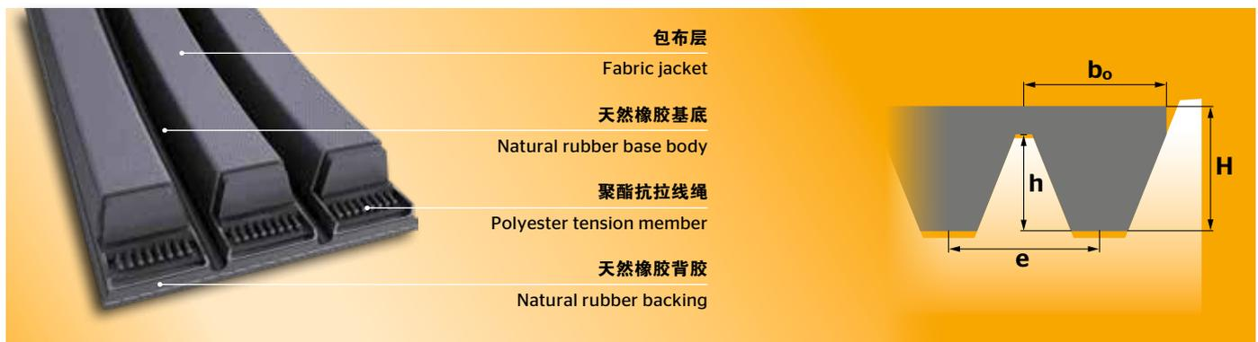
CONTI®V MULTIBELT 通常用于中心距较大和灰尘较多的环境中, 如碎石机和冷铣刨机。同时, 也适用于农业应用中。横向刚性背部可有效防止单条传动带的扭转和过度振动。
