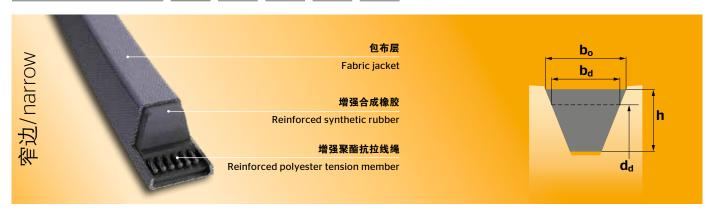
CONTI®V ADVANCE 专门为一般机械工程应用中的高性 能传动而研制。典型的应用领域包括压缩机、风机、建 筑机械和广泛的园艺机器。适用于离合器带和反向弯 折。CONTI® V ADVANCE 具备更长的使用寿命,因此长 期使用可有效地节约成本。
