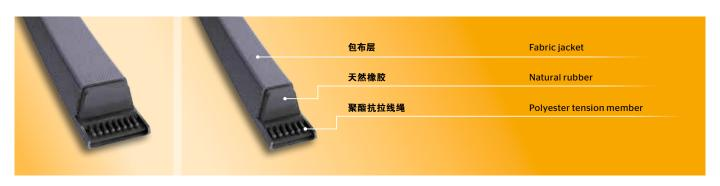
CONTI®V 符合 DIN 2215&DIN 7753 标准,适用于一般机械工程应用的高强度传动。尤其适用于小带轮直径的传动装置。典型应用领域包括诸如园艺和农业机械等。包布标准三角带也可作为 V- 平带传动使用。
