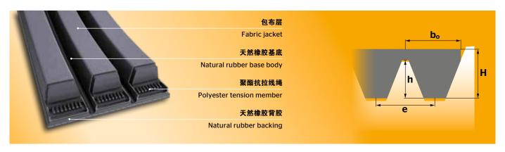
CONTI®V MULTIBELT 通常用于中心距较大和灰尘较多的环境中,如碎石机和冷铣刨机。同时,也适用于农业应用中。横向刚性背部可有效防止单条传动带的扭转和过度振动。
