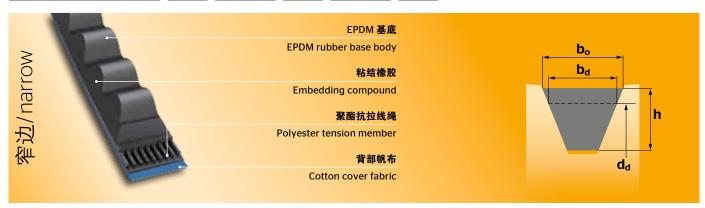
CONTI®V FO PIONEER 可替代任何与包布三角带匹配 的传动系统。典型应用领域包括:压缩机、施工机械、 电动切割机、排气扇、石油工业专用泵。三角带十分耐 用,竞争优势在于它的系统成本比包布窄边三角带节省 50%。其优化后的齿面能够保证运行顺畅,并起到减小 振动的作用。
